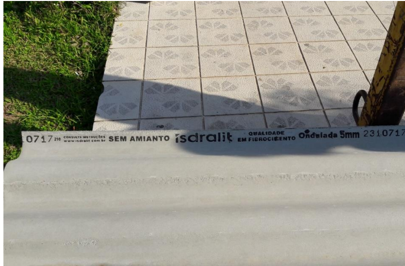
Figura 24: Telhas de fibrocimento. (Fonte: Dos Autores)
