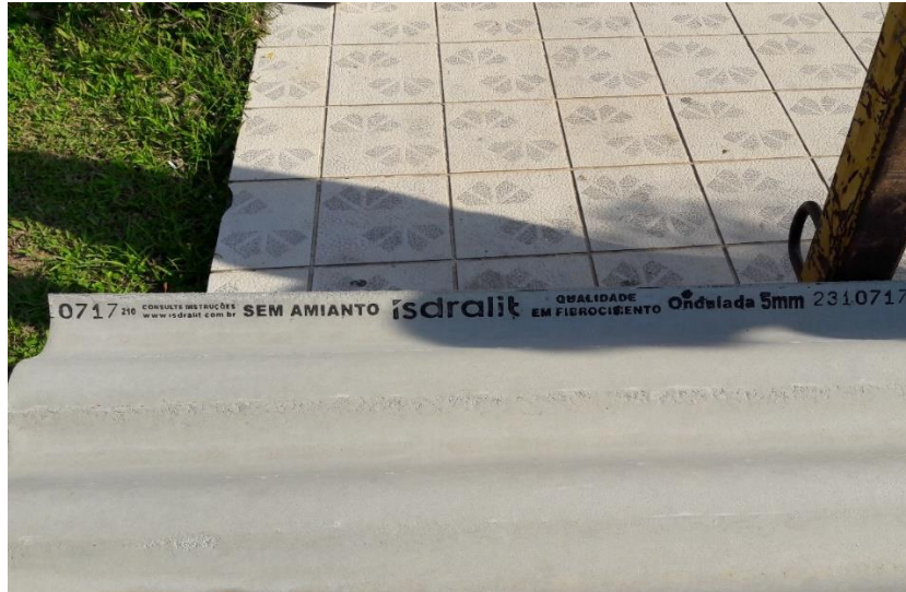
Figura 24: Telhas de fibrocimento. (Fonte: Dos Autores)
