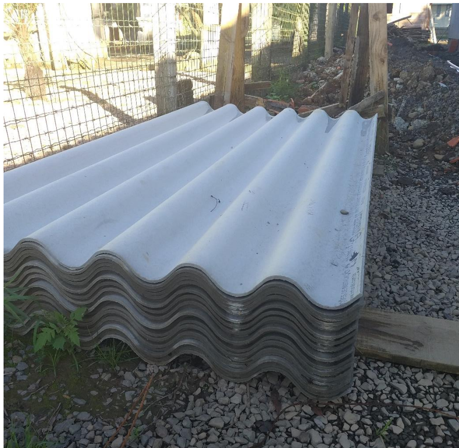
Figura 12: Telhas do tipo ondulada de fibrocimento (8mm). (Fonte: Dos Autores 2019)
