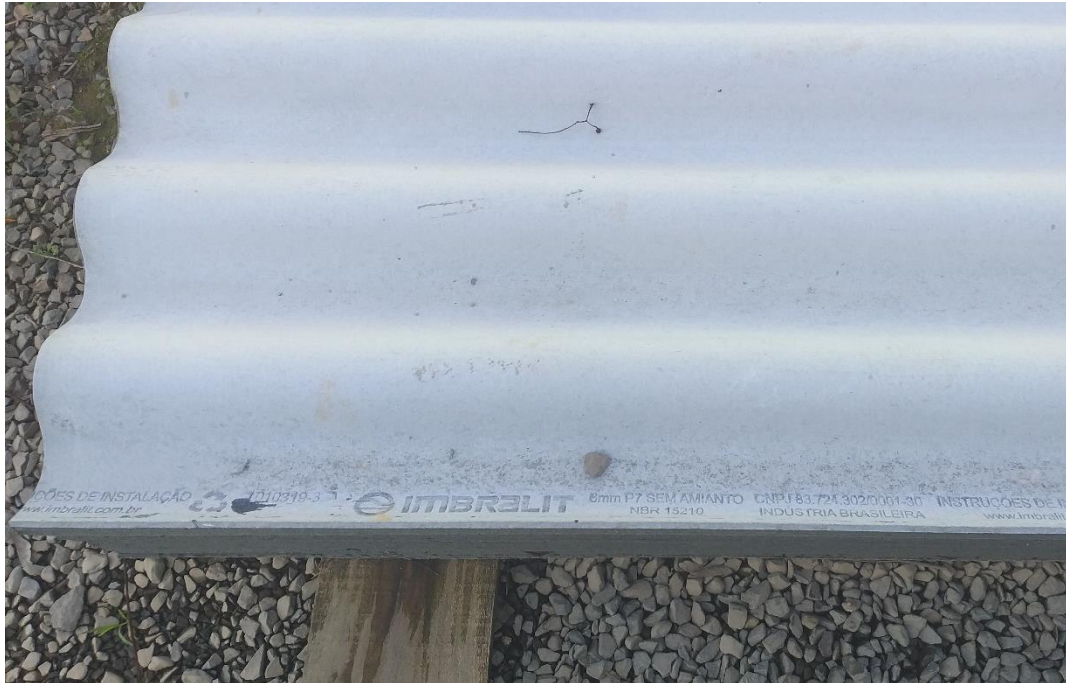
Figura 11: Telhas do tipo ondulada de fibrocimento (8mm). (Fonte: Dos Autores 2019)
